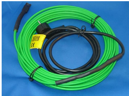
Thermostat et sonde incorporés pré-réglés pour enclenchement à +/- 7°C. Le câble ne peut pas être coupé.
