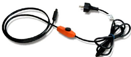
Thermostat et sonde incorporés pré-réglés pour enclenchement à +/- 7°C. Le câble ne peut pas être coupé.
