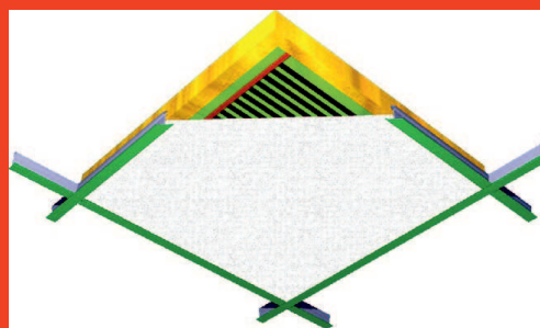
Montage dans l'ossature
